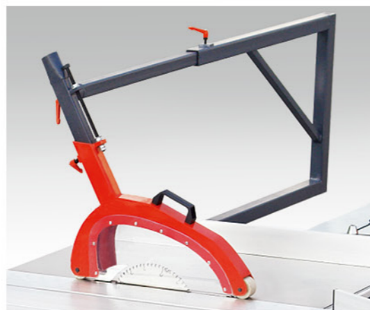
工厂大防护罩 Type-S protection hood
